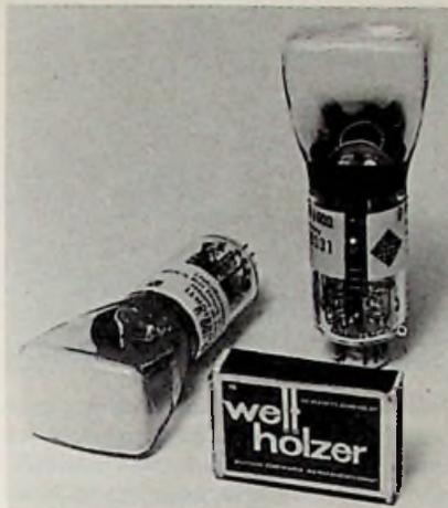
Für Mini-Fernsehgeräte und Anzeigezwecke in Meßgeräten ist die Kleinst-Oszillografenröhre D 5-100 von AEG-Telefunken bestimmt. Ihre Schirmfläche hat die Maße 30 mm x 40 mm.
