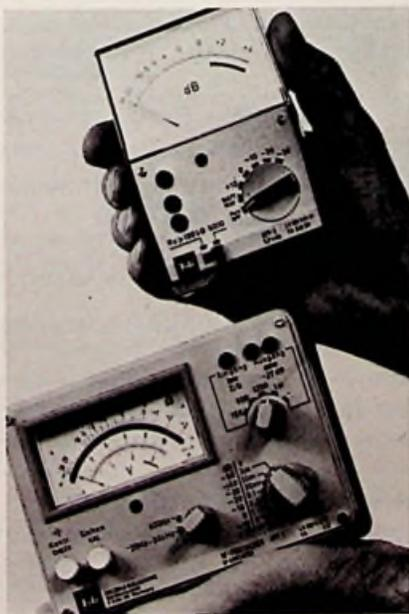
Geelignet für Pegelmessungen an Fern- sprech- und Rundfunk-Übertragungs- kanälen sind die handlichen Geräte
